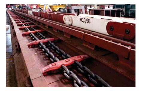
MINE PORTABLE CHAIN-AND-FLIGHT CONVEYOR КСД-28
